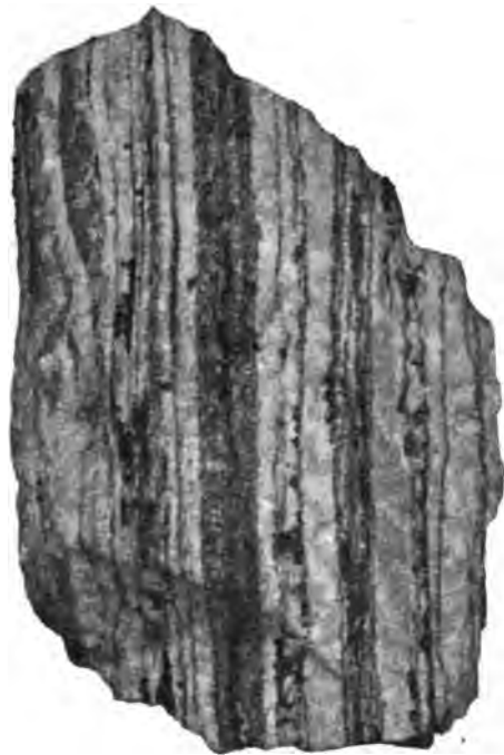
Fig. 4. Eben-lagenförmige Struktur auf Gängen. Kupferkies, Bleiglanz und Kalkspat. Burgstädter Zug. Oberbau.
